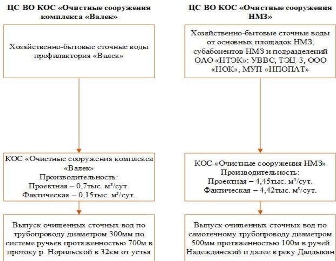
Рисунок 3 - Структурная схема централизованного водоотведения на территории КОС Валек, КОС НМЗ муниципального образования город Норильск
