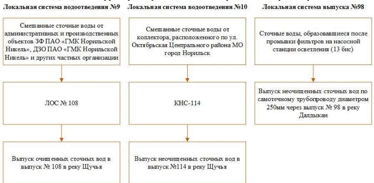
Рисунок 5 - Структурная схема локальных систем водоотведения № 9, 10, выпуска № 98 на территории муниципального образования город Норильск
