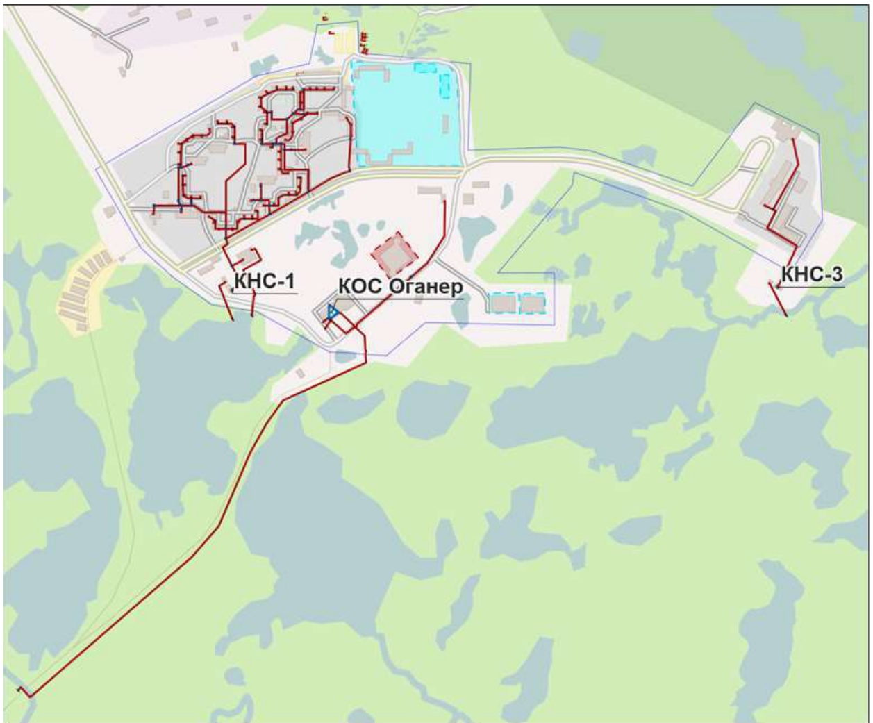
Рисунок 39 - Картограмма зоны действия централизованной системы водоотведения жилого образования Оганер на территории муниципального образования город Норильск
