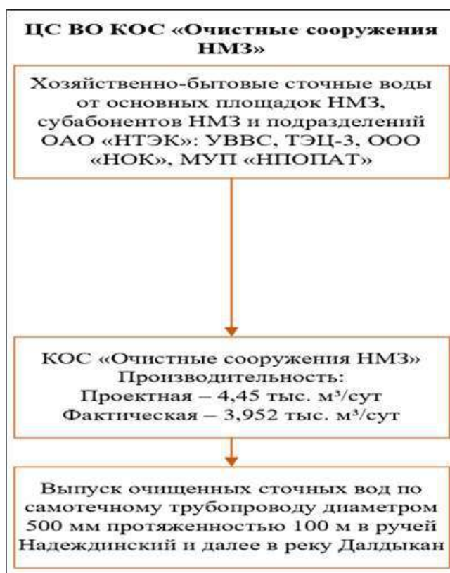
Рисунок 33 - Структурная схема централизованного водоотведения на территории КОС НМЗ муниципального образования город Норильск
